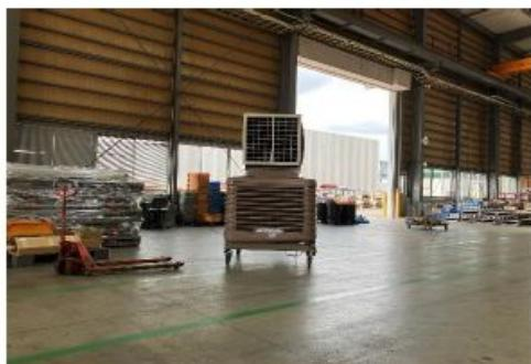
工場の出入り口付近に設置し外気を取り込み、涼風を生み出し、効率よく現場作業員の体感温度を下げるのに活用しています。
