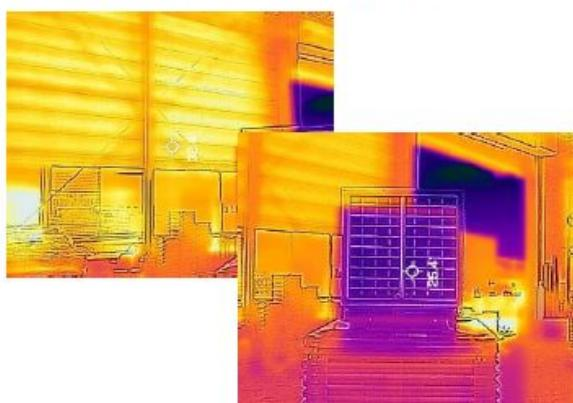
工場内温度 32.4°C の時のネオクールの吹き出し口表面温度 25.4°C
