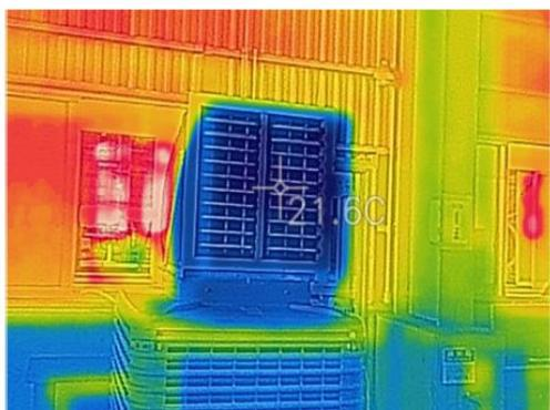
工場内温度約 26°C の時のネオクールの吹き出し口表面温度
